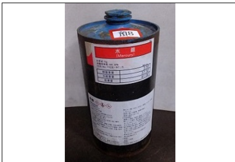
図 2.1 水銀を貯蔵する容器の例
