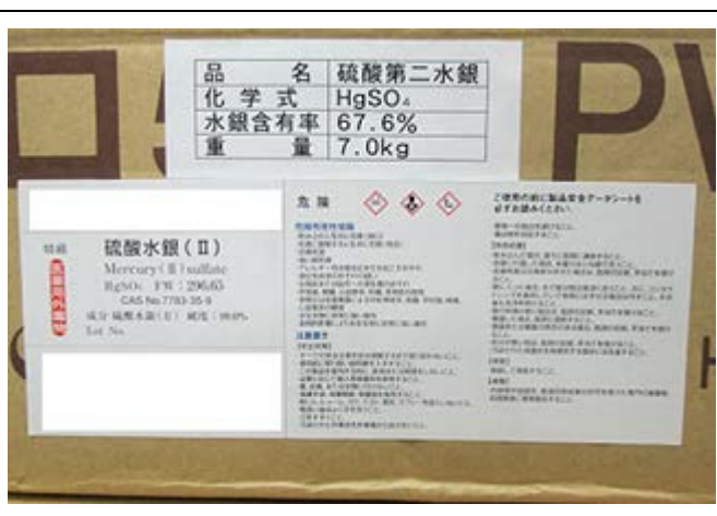
図 2.2.2 水銀化合物の貯蔵の表示例
